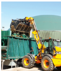
◀ Das Gras gelangt per Teleskoplader in den Dosierer. Von hier befördern es Staigschnecken in den Fermenter.
